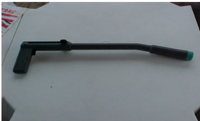
Figura 3: Aplicador do transponder intra-ruminal. Fontes: Lopes (2001).
